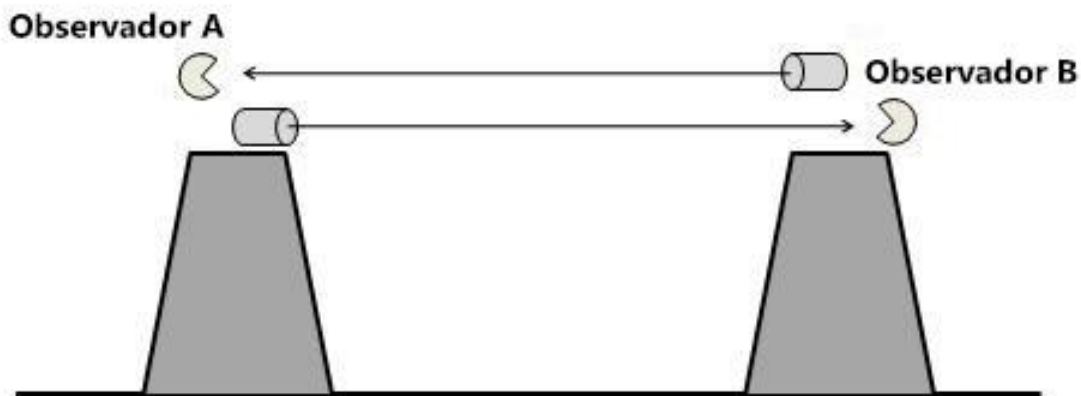
Figura 3.22. Esquema de l'experiment de Galileu per determinar la velocitat de la llum.
