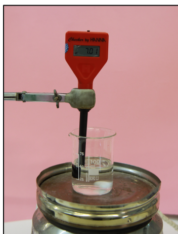
Figura 93. Muntatge del pHmetre (font pròpia).
