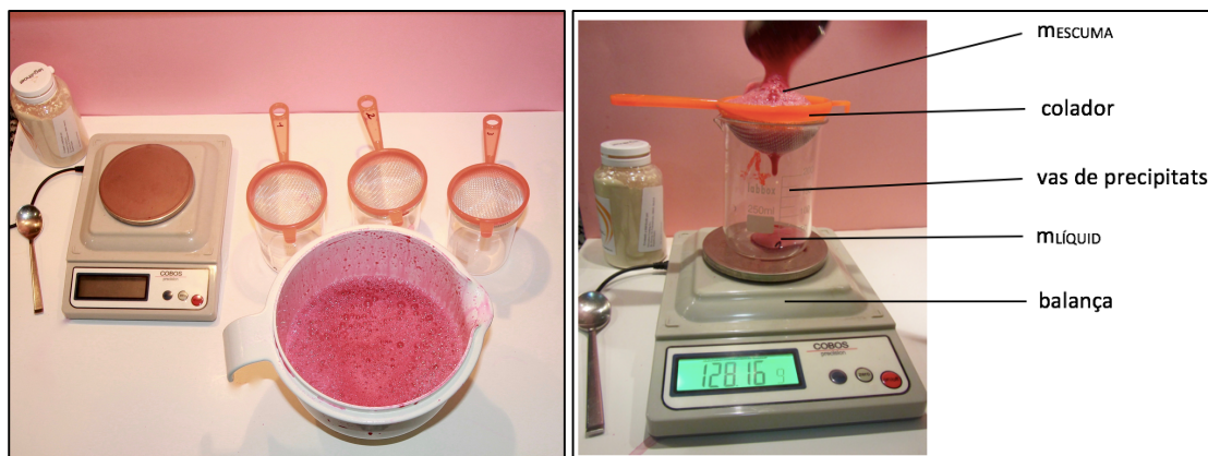
Figura 22. Muntatge emprat per a determinar l'estabilitat d'una escuma/aire (font pròpia).
