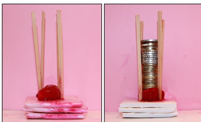
Figura 71. Texturòmetre casolà amb esferificacions inverses de 2, 4, 6, 8 i 10 minuts (font pròpia).
