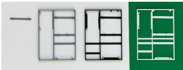
Fig. 30. Procés complet del disseny del primer nivell, començant amb la prova de muntura del arduino i acabant amb la versió definitiva.
