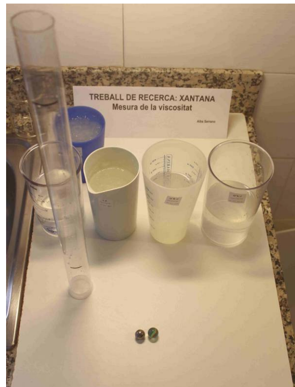
Imatge 6.18: Material utilitzat per determinar la viscositat per caiguda d'objectes (Font pròpia)
