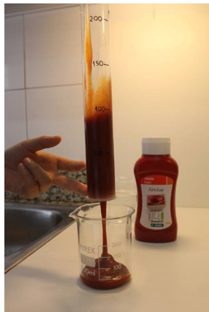
Imatge 6.27: Deixant caure el Ketchup a l'interior del got de precipitats a través del forat i mesurant el temps (Font pròpia)
