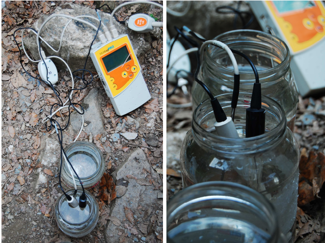
Fig. 97 i 98: Fotografies de la interfície i els sensors de pH, temperatura i conductivitat.
