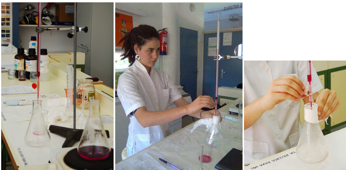
Fig. 138, 139 i 140: La Kim està fent la determinació de la DQO. Concretament està afegint permanganat potàssic a la solució d'aigua, permanganat i oxàlic que prèviament ha escalfat.
