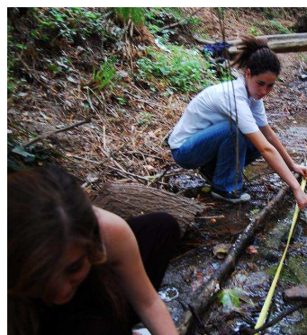
Fig. 105: Mesurant la distància que ha recorregut el tap per calcular la velocitat.
